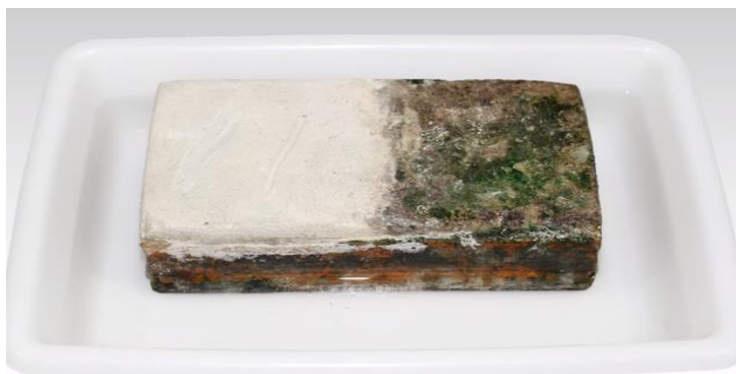
Figura 1. Corpo de prova RBTC: tijolo com produto (esquerda) e sem produto (direita).
