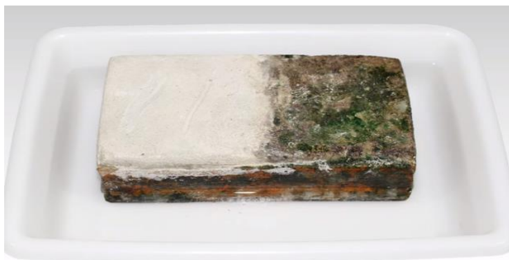
Figura 1. Corpo de prova RBTC: tijolo com produto (esquerda) e sem produto (direita).
