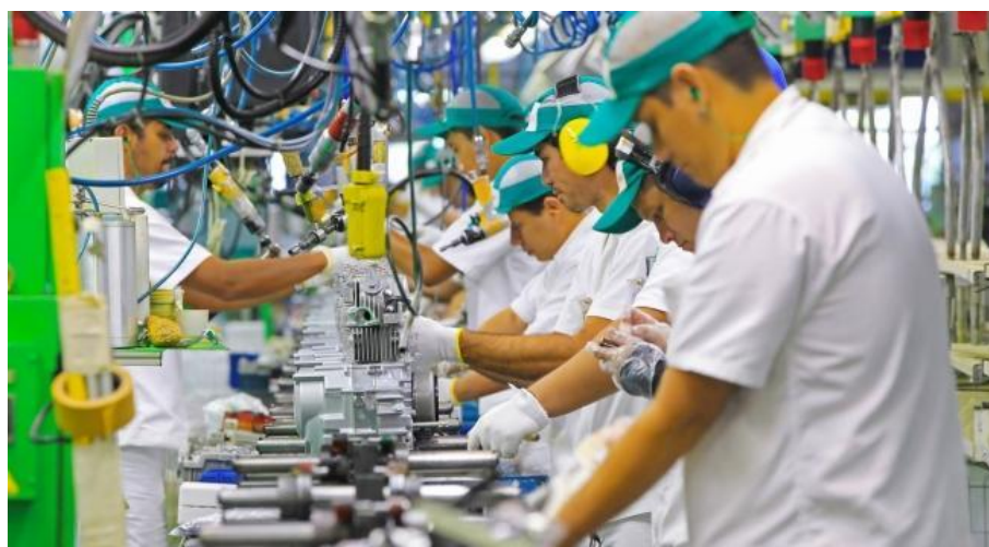
Figura 1 – Processo produtivo com ausência de espaço (quantidade enorme de equipamentos, cabos e mangueiras)
