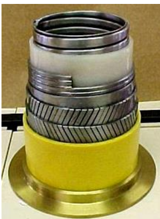
Figura 1. Composição de uma linha flexível.
