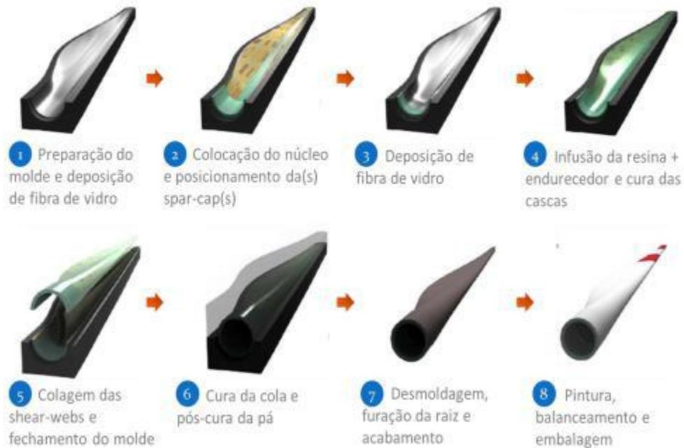
**Figura 5.** Processo produtivo de uma pá eólica
